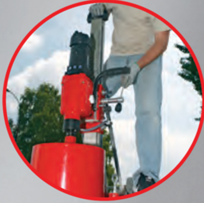
Dörtlü koruma sistemi: - Elektronik sistem - Termik sistem - Mekanik sistem - Yağlama sistemi
